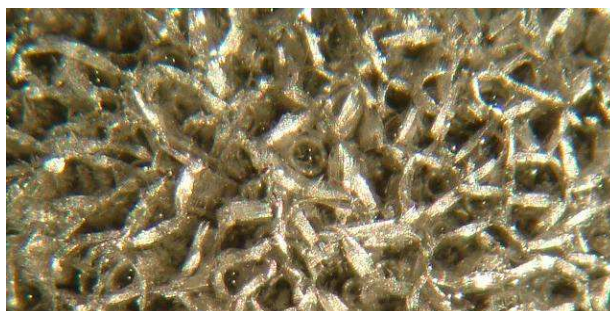
Figura 17 – Aspectos incríveis da química dos metais revelados pela lupa ou microscópio estereoscópico: cristais de estanho obtidos por reacção redox de placas de zinco com cloreto estanoso, ampliados 20x. Várias bolhas de hidrogénio, uma
