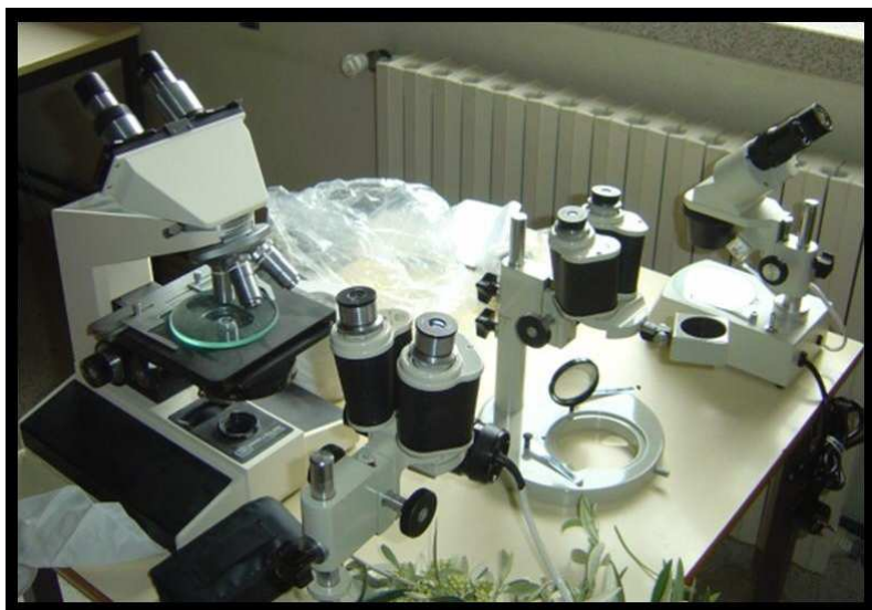
Figura 6 - Microscópio binocular, à esquerda e lupas estereoscópicas comuns usadas nas escolas do Agrupamento de escolas Ribeiro Sanches. É perfeitamente possível obter boas fotomicrografias com estas pequenas lupas, utilizando câmaras fotográficas digitais adaptadas ou simplesmente encostadas a uma das oculares. Um bom telemóvel também pode ser uma alternativa. http://web.ist.utl.pt/clementina/microscopia1 .
