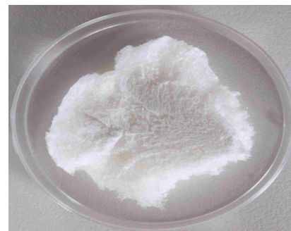
Aspecto do polissacárido gelano, após purificação e liofilização
